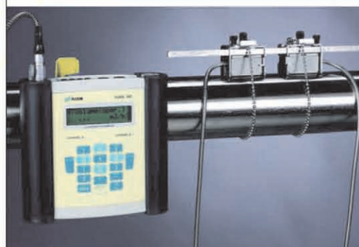
Senzorii ultrasonici fixați cu papuci și debitmetrul montat pe teavă cu sistemul QuickFix
